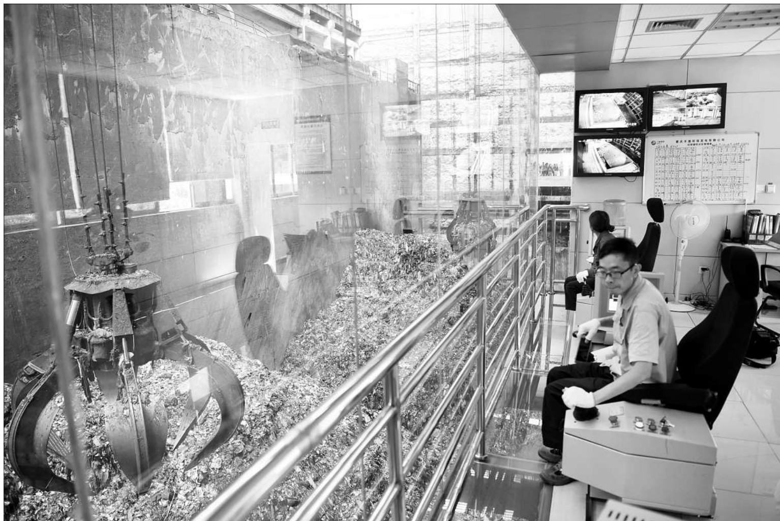
6月17日,重庆丰盛垃圾焚烧发电厂工作人员在操作巨型机械手抓取垃圾。
