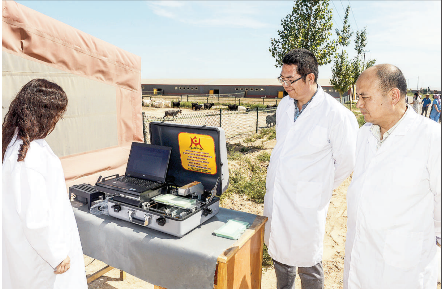
从采样到送检,再到结果反馈,原本至少需要3至5天的毛毡检测过程,如今在任何时候、任何地点,只需要40秒左右,就可以将毛毡的长度、细度等多项参数一起检测完毕,并且误差范围在0.2微米以内,高于0.3微米的国际标准。如此高效准确的毛毡检测技术来源于新疆畜牧科学院联合中国纤维检验局等单位,共同开发研究的全天候毛毡快速检测技术。图为6月8日,科研人员在新疆畜牧科学院羊绒科研基地利用检测仪检测羊绒。新华社记者 王菲摄
