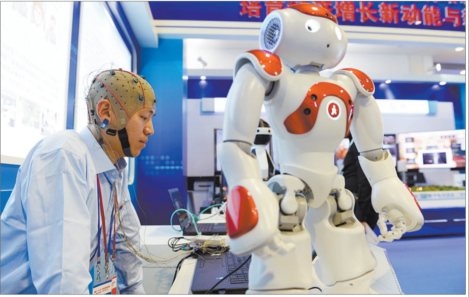
6月1日,国家“十二五”科技创新成就展在北京展览馆开幕。图为脑电控制机器人,该系统通过将人脑电波转换成指挥机器人的计算机指令,实现用脑直接控制机器人运动。 本报记者 周维海摄
