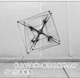
能上下盘旋、翻滚自旋的全方位飞行器模型
