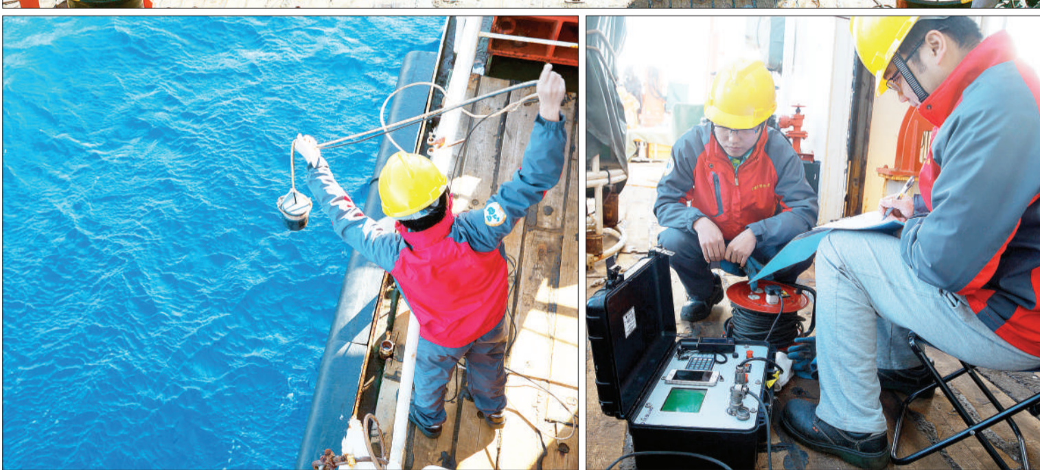
5月22日,在西南印度洋执行大洋科考第40航次第四航段科考任务的“向阳红10”科考船上的科考队员,在工作区域顺利回收在海底工作了117天的重达450公斤的深海沉积物微生物原位培养系统。该系统可布放到深海海水与沉积物界面开展微生物原位培养实验,实验完成后,可通过水声遥控,实现样品的无污染回收。 上图 科考队员在科考船后甲板回收深海沉积物微生物原位培养系统。左下图 科考队员在科考船后甲板布置声学甲板单元,回收声学探头。右下图 科考队员利用声学甲板单元“联系”深海沉积物微生物原位培养系统。 新华社记者 金立旺摄
