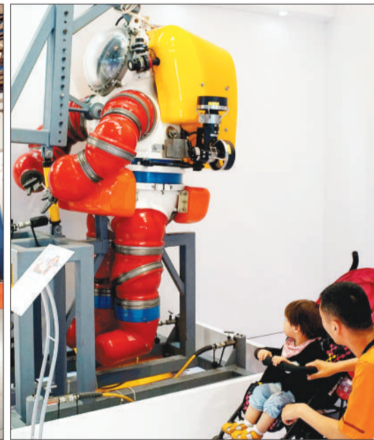
右下图 用于海底维修和救援的“单人常压潜水装置”。本报记者 周维海摄
