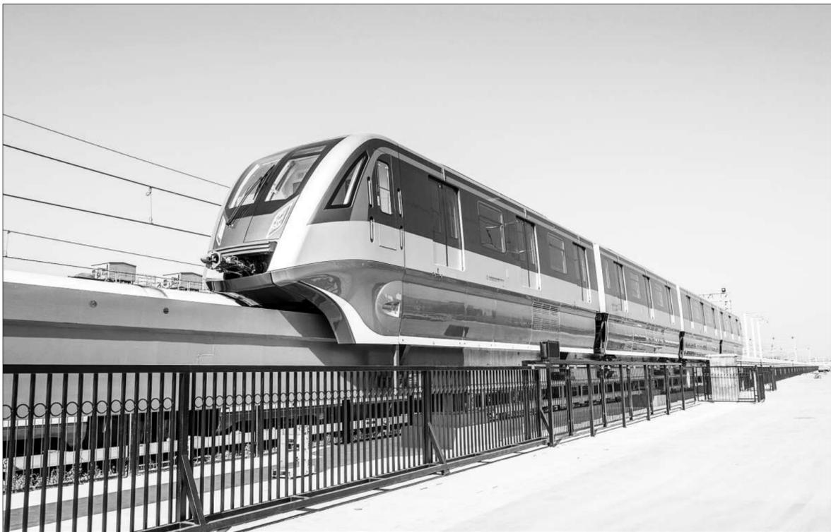
我国自主研发的首列永磁跨座式单轨列车5月19日在青岛下线。这种列车是国内首次采用永磁牵引技术制造，节能10%以上，达到国际领先水平，标志着我国在跨座式单轨车辆技术领域取得重要突破。车辆的最高运行时速为80公里，整车使用寿命长达30年。图为永磁跨座式单轨列车。
