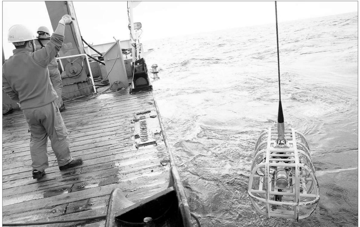
5月14日,正在西南印度洋执行大洋科考第40航次第四航段科考任务的“向阳红10”科考船开始利用集成化光学拖体考察工作区域。目前正在“向阳红10”科考船上执行的中国大洋科考第40航次第4航段主要任务是履行西南印度洋多金属硫化物勘探合同,对多金属硫化物进行合同区勘探。该航段将计划完成190公里长度的光学拖体考察。图为在“向阳红10”科考船后甲板上,科考队员将光学拖体投入海。
