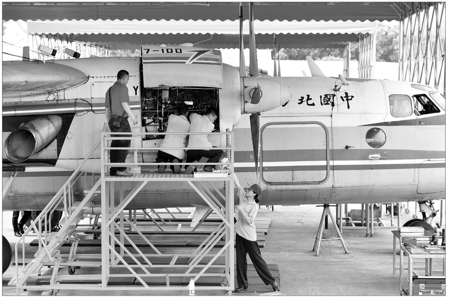
5月12日,2016年全国职业院校技能大赛(高职组)“飞机发动机拆装调试与维修”赛项在广州民航职业技术学院白云机场校区开赛,来自全国16所航空类院校的21支代表队齐聚广州一决高下。图为参赛选手在“涡桨-5型发动机高压油泵拆装”项目比赛中操作。
