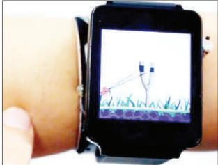
智能手表屏幕大小不便操作,把手臂也当成输入界面就好。卡内基·梅隆大学里的一个未来交互研究小组提出了一套叫Skin-Track的方案。方案提出智能手表再配备一组传感器,使用者的操作手指也得戴一个与之相匹配的指环。当操作指接触到佩戴手表手臂的皮肤时,会通过皮肤发出一道生物电信号,手表会根据接触点和表带上四个传感器的距离,测算出这个信号在手臂上的位置。
