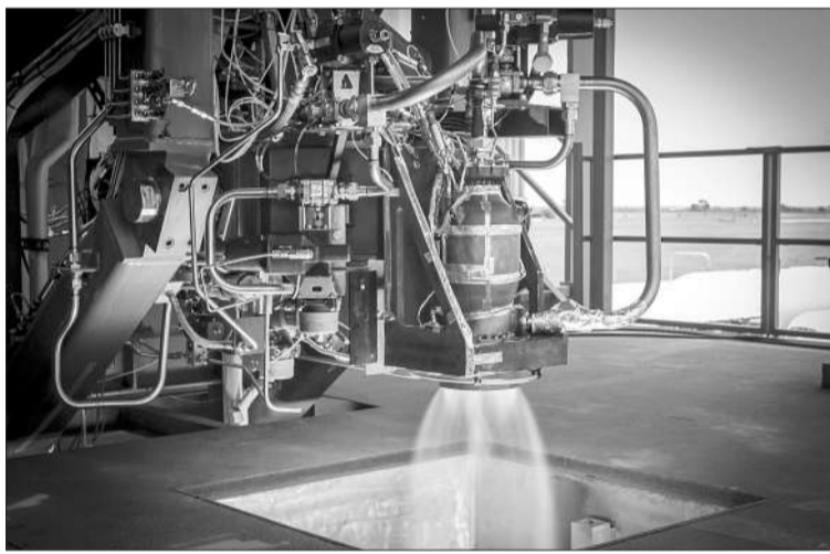
SuperDraco发动机在进行测试,其关键部件燃烧室是在3D打印机上完整打印出来的。
