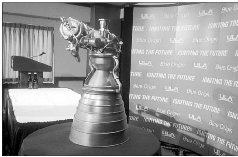
BE-4发动机模型,它将用液化天然气为火箭提供动力。
