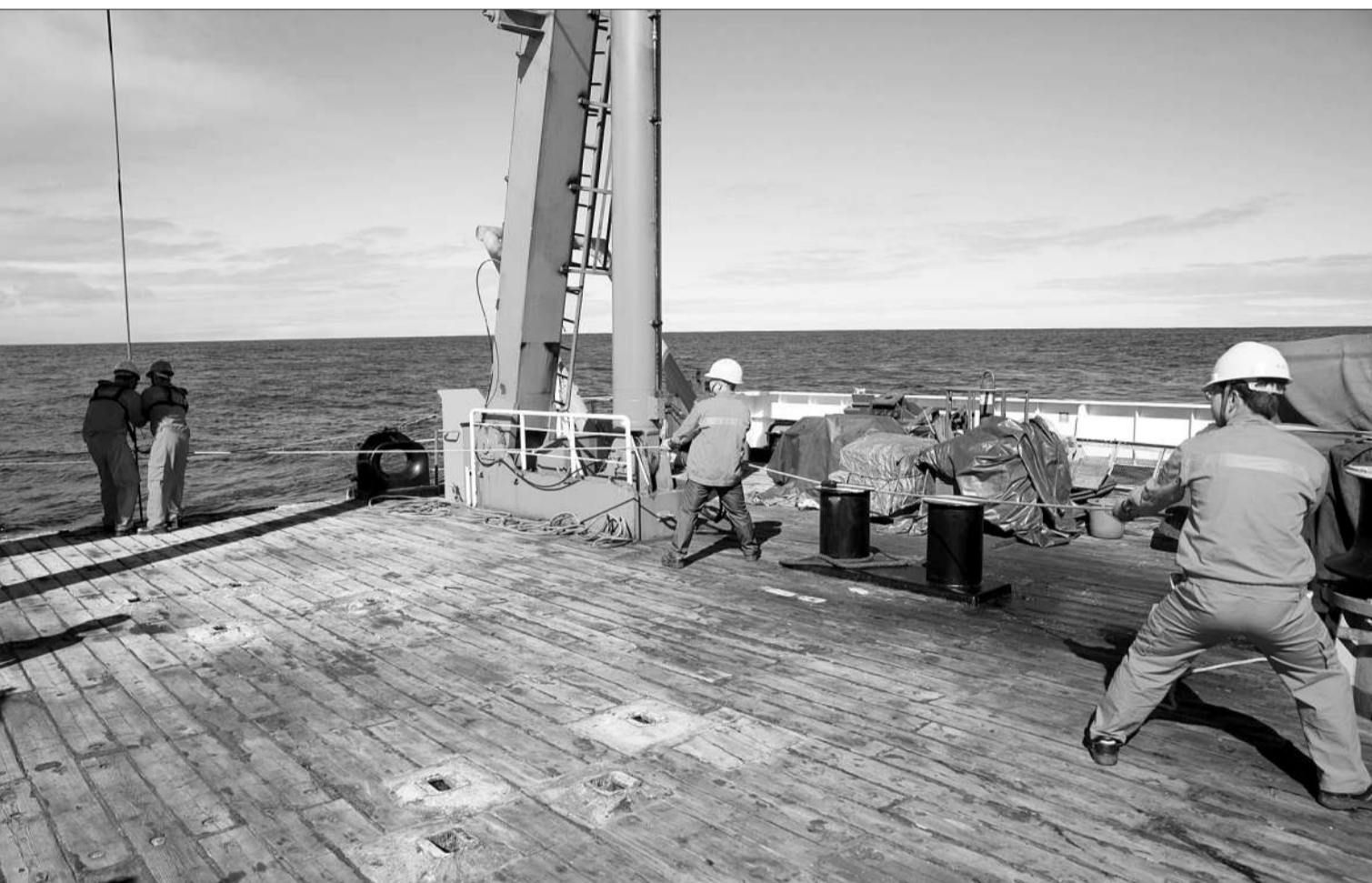
4月28日,“向阳红10”的科考队员在可视抓斗的同轴缆上安装用来探测热液的浊度、温度和压力的实验设备。当日,载着中国大洋第40航次第四航段全体船员和科考队员的“向阳红10”科考船来到西南印度洋工作区域,进行第一次可视抓斗投放。可视抓斗重达2.4吨,可投放至深达4000米的海底,通过摄像机观察海底,根据需要在海底表面抓取采样。
