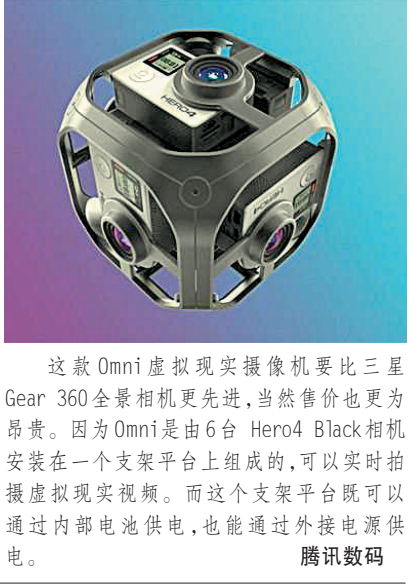
这款Omni虚拟现实摄像机要比三星Gear 360全景相机更先进,当然售价也更为昂贵。因为Omni是由6台Hero4 Black相机安装在一个支架平台上组成的,可以实时拍摄虚拟现实视频。而这个支架平台既可以通过内部电池供电,也能通过外接电源供电。
