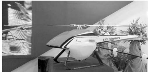
4月19日上午,植保无人机品牌天鹰兄弟在北京国际展览中心召开新品发布会,正式发布最新研发的第四代全智能电动植保无人机——TY-800。据介绍,第四代全智能电动植保无人机TY-800采用全封闭外观设计,法拉利散热孔工艺设计,确保航电系统散热通风,材料采用高强度复合材料,耐磨、耐腐、防虫、防沙的工业级设计产品,载重高达25公斤,每小时作业面积可达110—120亩,作业效率是人工喷洒的60—80倍。
