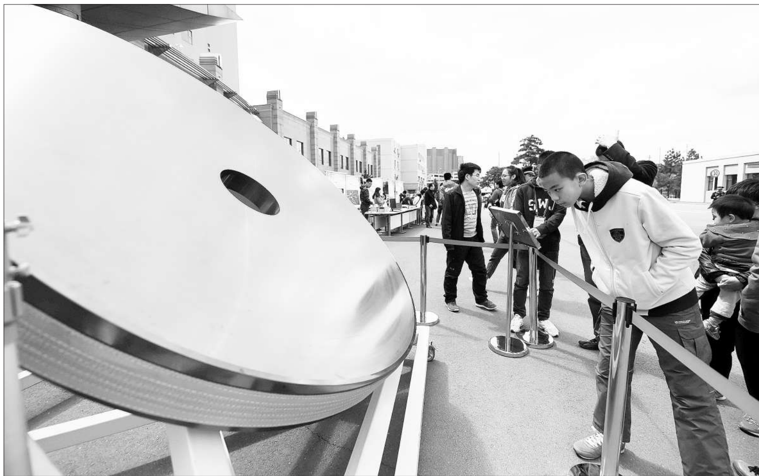
4月23日,中国科学院长春光机所(简称长春光机所)举办以“科技创新 追梦未来”为主题的航天日科普系列活动。通过科普讲座和航天相关产品展览向公众展示航天科研成果,为市民进行航天知识科普,迎接“中国航天日”的到来。图为市民在长春光机所参观展出的直径两米单体碳化硅反射镜坯,它是航空、航天相机或地基望远镜的反射镜材料。
