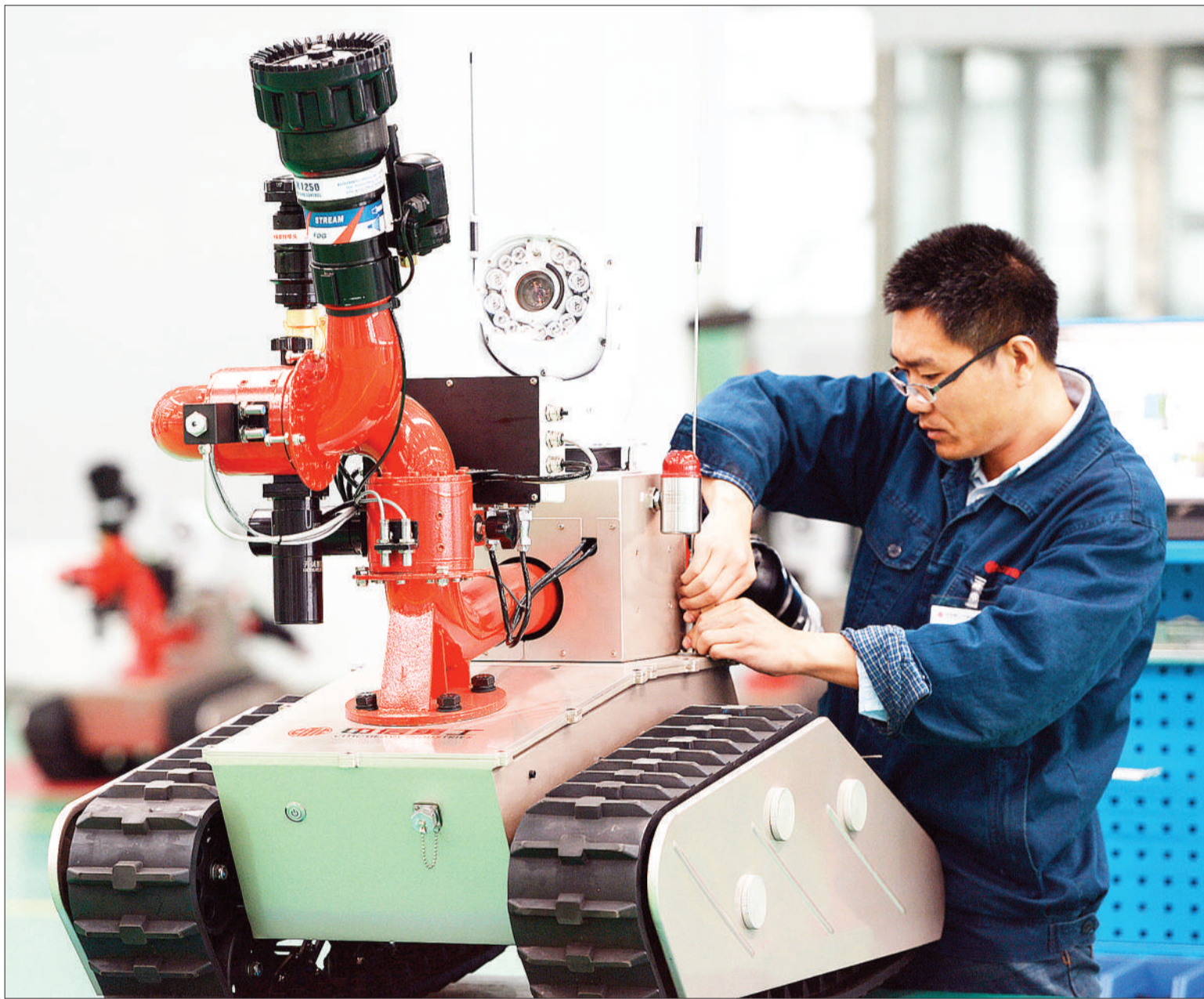
近期,中信重工开诚智能装备有限公司的员工正在加紧生产国内首家具备认证资质的防爆消防机器人。这类特种机器人主要用于石油、化工等高危领域,能够代替相关人员进行事故现场进行探测、搜救、灭火,并将探测到的数据实时回传到控制指挥中心。该产品投放市场之后,订单不断,迅速成为中信重工新的业务增长点。
