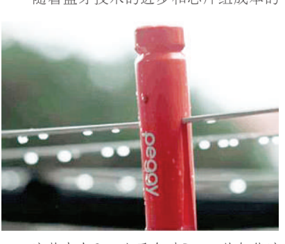
这款来自Omo公司名叫Peggy的智能晾衣夹,可以像普通晾衣夹一样被挂到晾衣绳上,并且可以通过内置的光线、温度和湿度传感器来检测天气。
