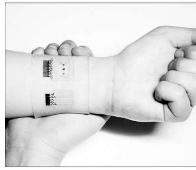
图为石墨烯制成的柔性糖尿病管理贴片,这种仅有一张扑克牌大小的透明塑料薄片,在被贴在皮肤上后,不仅能监测血糖,还能在必要时通过皮肤释放药物降低血糖水平。
