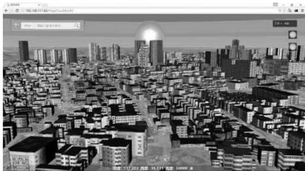
模、互联网大数据等空间数据的集成和一体化管理。依托空间大数据一体机强大的服务能力,提供全球中分辨率和亚洲区域高分辨率卫星影像以及行政区划、地名地址等基础地理信息服务。平台基于软件即服务的云计算架构,以网络服务的方式提供地图浏览、数据管理、查询检索、分析处理、在线专题制图等上百种空间信息系统的功能。用户无需安装专业的GIS软件,通过网络浏览器、手机、平板电脑等终端登录平台,就可以利用平台提供的空间信息资源和GIS功能进行地图浏览、空间分析、统计等数据分析和处理。作为平台核心系统的三维数字地球系统充分利用GPU硬件加速技术,实现了全球海量多源遥感影像、地形等空间数据流畅显示,实时在线三维分析和海量三维城市模型的平滑浏览。与谷歌地球(Google Earth)等互联网空间信息服务相比,本平台提供丰富的空间数据分析处理工具,对于行业空间信息应用系统的构建具有重要的意义。目前,成果已经成功应用于公安边防、警用地理信息、智慧城市等诸多领域。
