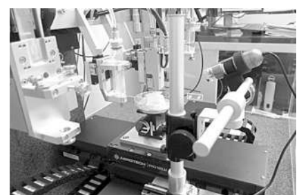
维克森林大学用来制造器官、组织和骨骼的组织和器官集成打印系统(ITOP)
