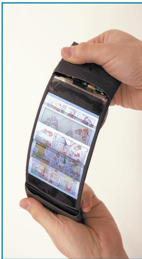
▲由加拿大女王大学的人类媒体实验室的研发人员制作出,一块手机搭配LG公司720p柔性OLED触摸屏,屏幕背面则有弯曲传感器和力反馈器。
