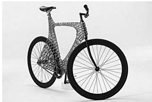
这辆结构复杂的自行车车架来自荷兰MX3D实验室,他们使用融合了3D打印技术的灵活机器人手臂来完成车架的成型和焊接,车架坚固抗颠簸,已通过了实际骑行测试。这种3D打印技术的成熟对于制造大型一体化部件很有帮助。
