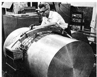
一个大铝筒。基本原理是,如果引力波的频率跟铝筒的共振频率一致,会引起它的收缩一拉伸。旁边的人叫乔·韦伯(Joe Weber),公认的引力波探索先驱。他曾在1969年宣布,用这台机器测到了引力波。
