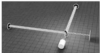
其基本原理是,把引力波扫过导致的长度变化,转变为激光干涉结果的光强变化。“干涉”几乎是精密测量的“作弊器”,不用什么别的工具,我们可通过手机贴膜不均匀处的干涉条纹,直观看出贴合间距的微小变化。LIGO也能通过测量两束相干红外激光的干涉光强,判断激光臂长的极微弱变化。
