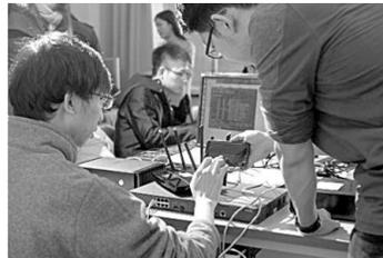
寒假期间,设在北京交通大学的下一代互联网设备国家工程实验室里,老师和同学们正在做高速列车上无线路由器的测试。高速列车移动路由器以“国家973项目”为基础,旨在为高速列车提供稳定且高带宽的互联网接入服务。高速列车移动路由器基于智慧协同网络思想,自2011年以来多次在高铁测试线路上实验应用,显著改善了高速移动环境下的车载互联网状况,提高了乘客用户的互联网接入体验。
