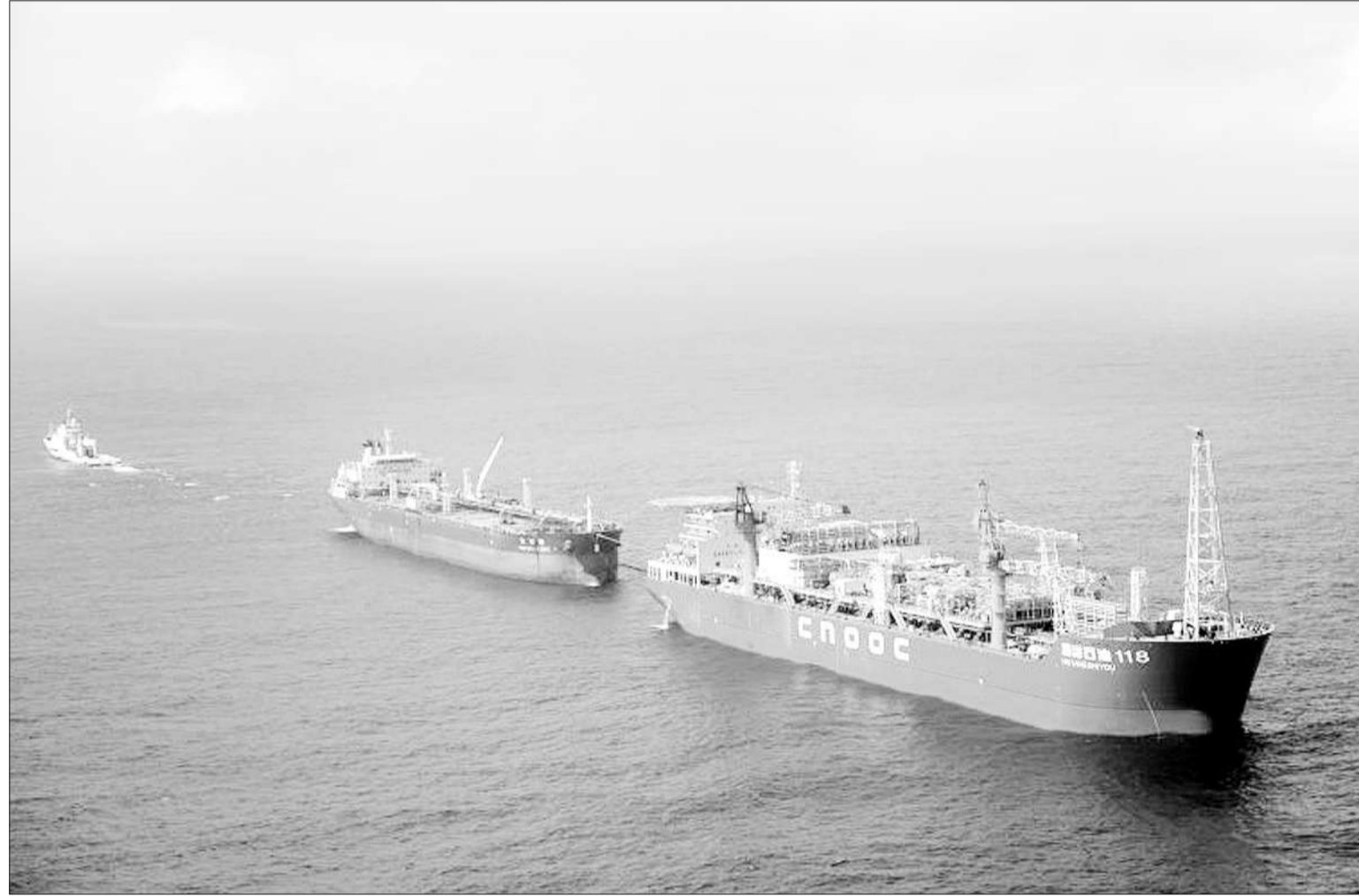
由我国自主设计建造的“海洋石油118”FPSO即“浮式生产储卸油装置”,2015年外输原油比年初计划超出22%,其中生产时效99.45%、主要设备完好率100%,表明我国FPSO运营管理已达到国际先进水平。作为开发海洋石油的关键设备,FPSO是集生产处理、储存外输及生活、动力供应于一体的综合性大型海上生产设施,素有海上油田开发“航空母舰”之称。
