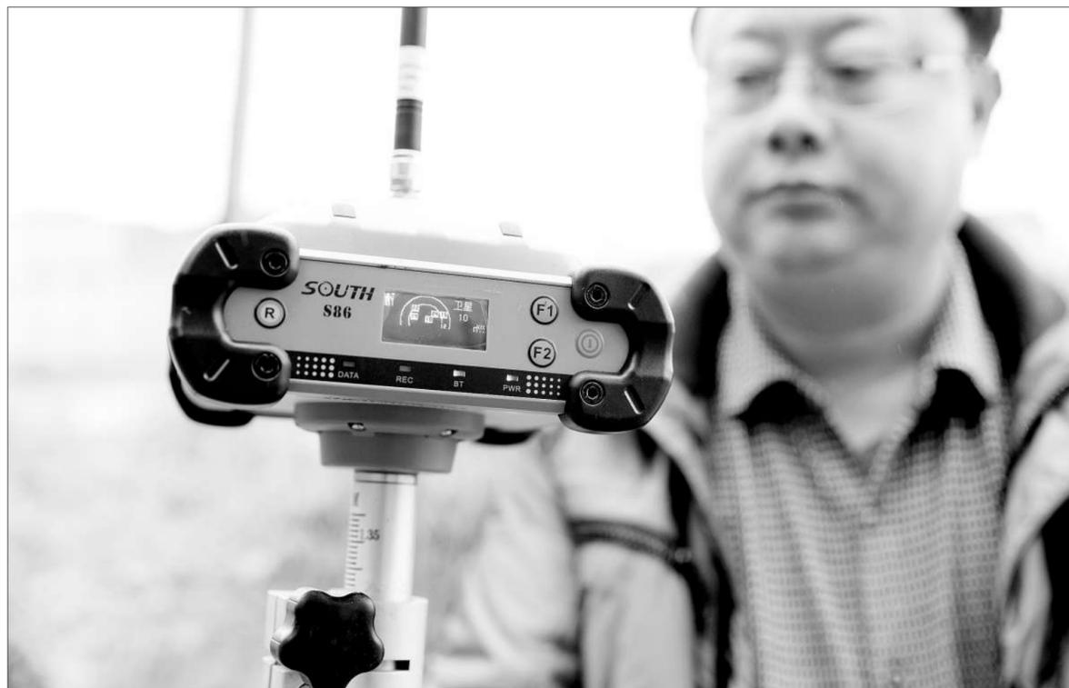
近年来,贵州省遵义市汇川区多措并举从严保护耕地,为粮食安全提供保障。2014年初,汇川区国土局为执法大队选派精兵强将,并在2015年给执法大队和各镇国土所配备了用来收集违法用地准确数据的RTK测绘仪、监控耕地巡查情况的GPS定位仪,以及摄像机、照相机、录音笔等设备。汇川区还积极探索“裁执分离”土地执法改革新机制,即强制执行由国土部门申请、法院负责受理审查和裁定、政府部门具体实施执行,同时责令当事人对被破坏耕地及时恢复耕作层,确保耕地满足种植条件。图为在贵州省遵义市汇川区高桥镇高石村,工作人员在用RTK测绘仪测量土地违法地块坐标。
