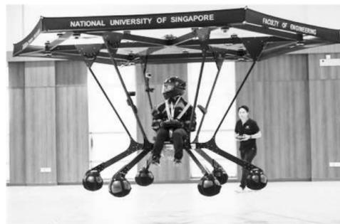
新加坡国立大学的团队开发了一款名叫Snowstorm的无人机,其最大特点是可以载人飞行。Snowstorm呈六边形,有24个马达,能够承载最重70kg的用户飞行5分钟。搭乘的人可以控制飞行情况,地上的人也可以进行控制。该机底部设有充气球,可以提供着陆时的缓冲,以保证乘客安全。
