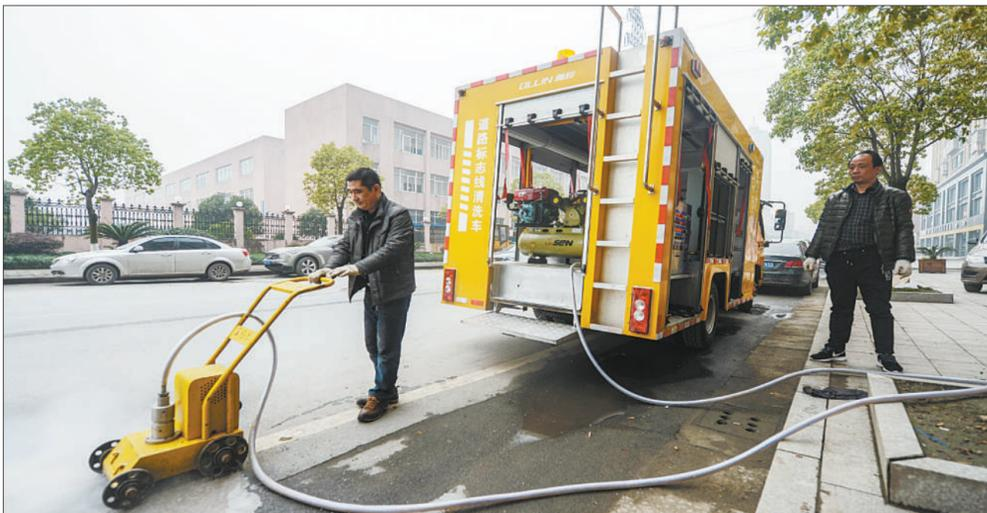
近日,一款应用“TK型超高压清洗设备技术”的高科技“道路标志线清洗车”在杭州问世。传统改画道路标志线方法效率低,污染大,又容易损伤原有路面。现在通过车载超高压水流清洗,高压水流在每平方厘米的地面上产生约1500公斤的压力,喷射出的水变得像刀一样锋利,油漆斑马线很快就消失了。 新华社记者 徐昱摄
