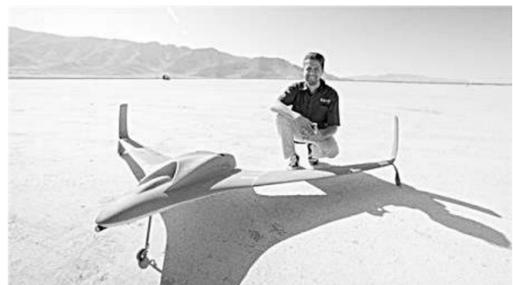
3D打印公司Stratasys与Aurora Flight Sciences联合开发了这款全球首款喷气式3D打印无人机。重量仅为15公斤,翼展3米,最高时速可达241km/h,其80%的部件由FDM工艺熔融沉积制造,主体打印约需9天,整架打印时间约为2-3周。
