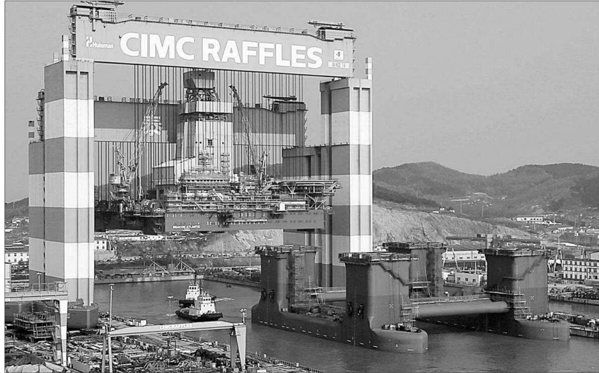
11月28日,由烟台中集来福士海洋工程有限公司为挪威建造的“大西洋之光”北极半潜式钻井平台在山东烟台完成上下船体合拢。这是我国建造的第二座适合北冰洋海域作业的深水半潜式钻井平台,标志着我国海工企业自主设计建造的深水半潜式钻井平台已形成批量化生产。该平台最大工作水深500米,可升级至1200米,最大钻井深度8000米;配置了DP3动力定位系统和8点系泊系统;最低服务温度为零下20摄氏度,满足冰级需求。图为“大西洋之光”下部船体被牵引至船坞准备合拢。 新华社发(唐克摄)
