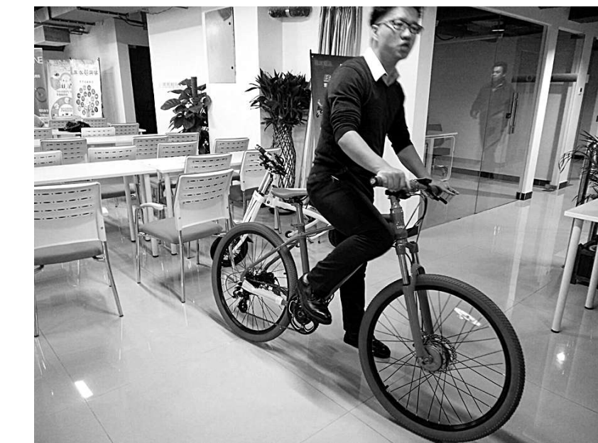
▲Begin ONE智能混合动力山地车采用250W电机,时速可达25公里,重量仅为18.4Kg,续航里程达到45KM,充电时间仅需2.5小时,隐形电力系统,可人力和电力自由切换,增加骑行选择并且智能识别人的骑行状态和路况,输出合适的动力。
