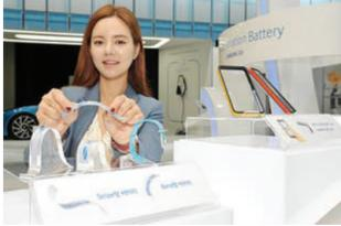
这是三星最新Stripe带状电池和Band带状柔性电池。Stripe电池内部密度很高,能弯曲成不同形状,还可以像衣物纤维一样被织入到衣物里面。Band电池能将智能手表的续航时间提升50%,并可以承受超过5万次弯曲。
