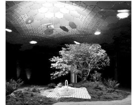
筹建地下公园的最大难题是如何使植物获得充足的阳光以继续生长。展览中展示过去几年用来在地下电车车站使植物生长的先进太阳能科技。这一科技是在地面收集阳光,然后让阳光渗透到20英尺下的地底,并照射整个地下公园。
