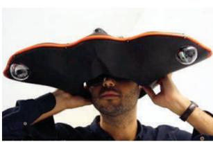
伦敦大学学院互动设计实验室开发了一款叫做“PolyEyes 2.0”的头戴式设备,模仿变色龙眼睛,利用仿生学原理,在两个透明塑料半球里有可以四处旋转的摄像头,每个摄像头都可以独立转动,佩戴者在头盔内的显示屏上可以看到180度的视野,且左右眼会看到不同的景物。
