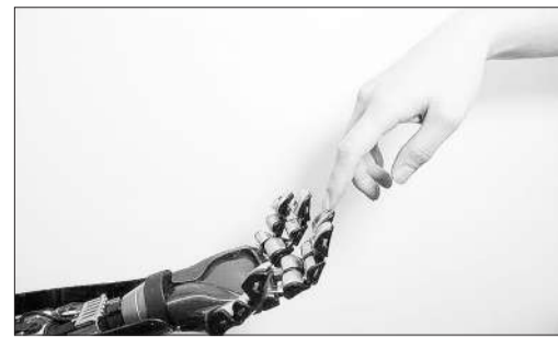
人类手指触摸机器人手指。机器人的“指尖”上是一种类似皮肤的传感器,由透明塑料与黑色装置构成。传感器能检测出触觉压力,并将这种信号传输给神经细胞。研究的目的是造出布满这种微型传感器的人造皮肤,用于义肢,使其拥有类似皮肤的某些感觉功能。
