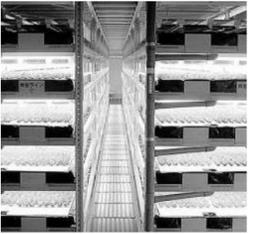
日本 Spread 公司将于 2017 年建立世界上第一个机器人农场,预计每年可以生产 1000 万棵生菜,用机器人代替人工劳力。机器人能够实现蔬菜种植自动化,从播种、发芽、收割和递送一条龙服务。同时,他们还监控二氧化碳指数和光照条件。
