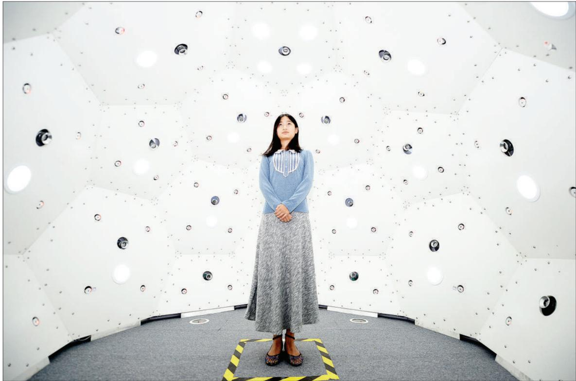
近日,由西安蒜泥科技的创客团队研发的Visbody三维人体扫描仪实现了360度人体瞬时扫描。Visbody三维人体扫描仪采用多视图融合技术,选择了93个500万像素的摄像头作为采集单元,通过穹顶式设计的设备,只需1秒就能完成采集,随后生成全彩三维模型,精度达到0.1毫米。三维人体扫描仪未来将应用于虚拟试衣、整形美容、影视动漫等领域。图为蒜泥科技的工作人员在测试Visbody三维人体扫描仪。新华社记者 李一博摄
