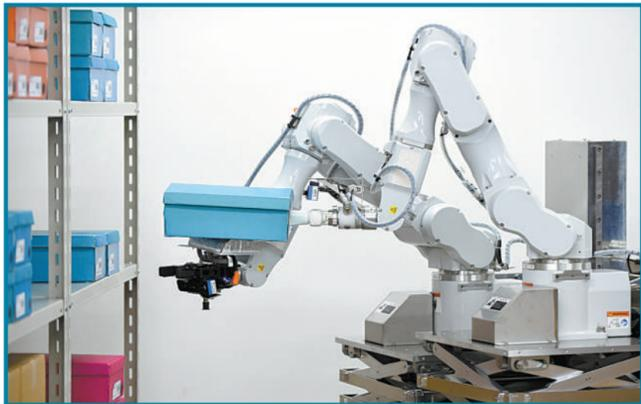
8月25日,日本日立为仓库工作研发的拥有两只手臂的原型机器人向媒体展出技能,这款机器人能够代替人,从货架上将货物搬下来,然后自动放入到箱子中。
