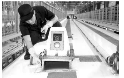
为保证动车组运行安全,重庆北动车所坚持人防、技防和人防“三防合一”筑牢动车组安全防护网,持续加大对动车组受电弓、制动系统等关键部位的检查力度,紧盯专项作业细节,及时补强薄弱环节,有效提升了设备质量,为“三个出行”保驾护航。图为重庆北动车所工作人员对动车组“升降弓监视器”进行技术调试。 陈亚摄
