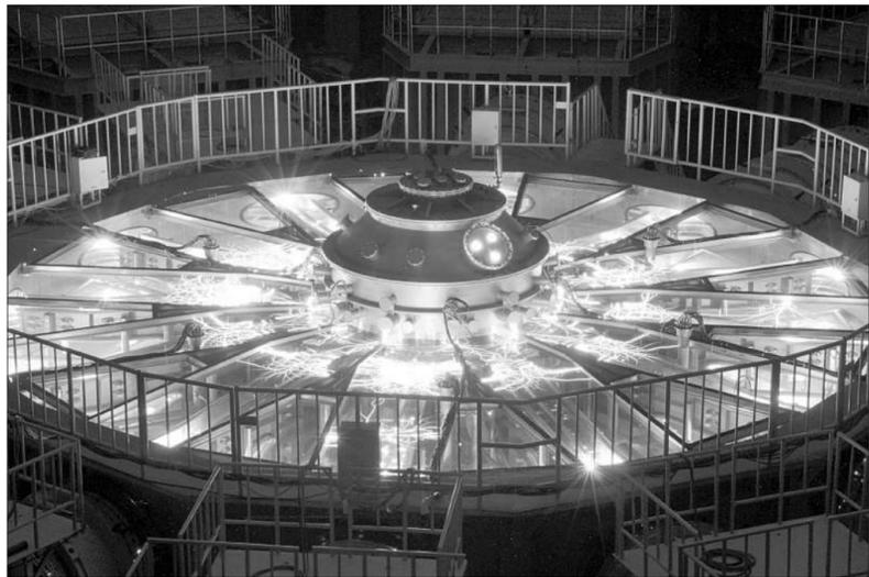
图为超功率脉冲装置聚光一号放电瞬间
