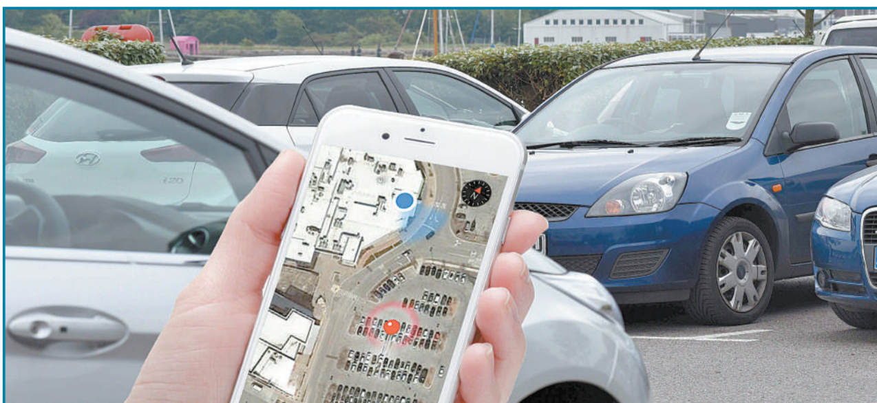
科学家发明的一款自动停车仪。下载一款免费的手机应用程序,将定位设备插入汽车电源插座,定位设备就会通过蓝牙发送信号在手机上显示停车位。
