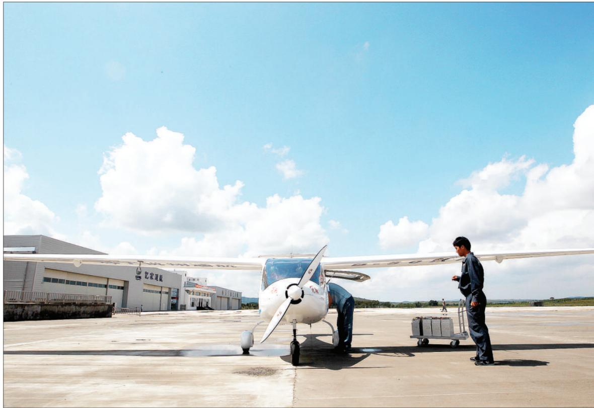
国内首款电动动力轻型运动飞机交付仪式6月18日在沈阳法库财湖机场辽宁锐翔通用航空有限公司机库举行。这款飞机由沈阳航空航天大学、辽宁通用航空研究院研制,采用自主设计制造的全复合材料机体结构,电动力的双座新能源通用飞机拥有完全的自主知识产权,是世界上第一款获得民航局适航证书的电动飞机。 CFP
