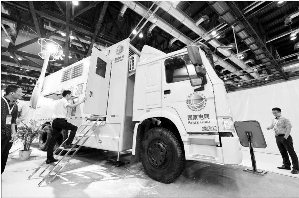
6月15日,第五届中国国际智能电网建设、分布式能源及储能技术设备展览会在北京国家会议中心开幕。展会展示了智能电网和储能领域的最新技术和产品。图为重庆迪马工业有限责任公司展示的新式移动应急电源车。该车具有发电机组可从车顶吊装,车内超静音设计,车底盘经过特殊改良,车箱体数控机床激光切割成型变形小等特点,保证了车辆的操控性和舒适性。
