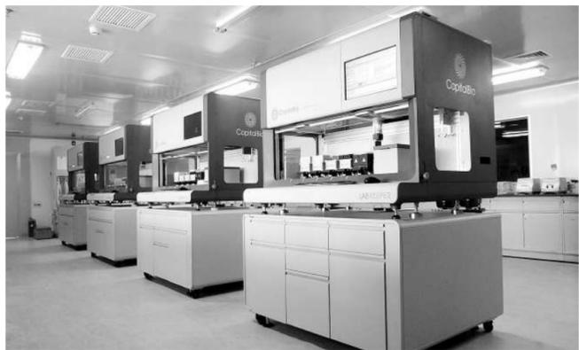
博奥生物集团自主研发的晶芯LabKeeper全自动液体工作站,实现了生命科学实验中各种液体处理的全自动操作,可用于核酸、蛋白及细胞等的提取、纯化等多项应用,集移液、振荡、加热、磁珠转移等多项功能于一体。
