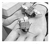
日前,在日本大阪大学的一个研究室内,被称为"赛博格(Cyborg)昆虫"的半机械昆虫正在不断诞生。研究者开发出利用昆虫体 液发电的装置,并将之安装在蟑螂等背上。
