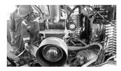
12月23日,正在西太平洋进行科学考察活动 的"科学"号科考船上搭载的"发现"号ROV深海 机器人(水下缆控潜水器)下潜至雅浦海山海域接 近4200米深处,挑战设计极限。
