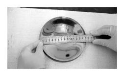
近日,中国科学院物理研究所北京凝聚态物 理国家实验室(筹)先进材料与结构分析实验室团 队人员与北京天科合达蓝光半导体有限公司合 作,成功研制出了6英寸碳化硅(SiC)单晶衬底。 据悉,碳化硅属于第三代半导体材料,是制造高亮 度LED、电力电子功率器件以及射频微波器件的
