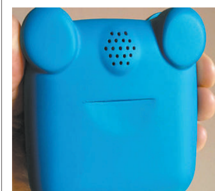
AirBeam是一款便携式、低成本并且可以随时检测空气质量的智能硬件。这个只有手掌大小的空气检测器通过基于光散射原理的检测方式,携带者可随时随地获得身边的PM2.5数值。
