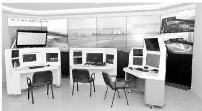
远程塔台——通过视频压缩、传输、拼接技术,在机场以外的区域实现塔台功能,具备指挥多个机场的能力。
