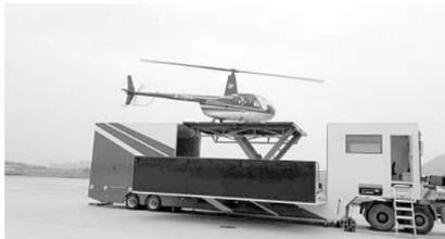
直升机移动机场——具有直升机机库、起降平台、塔台指挥以及地勤保障功能,保障直升机运输和野外作业。
