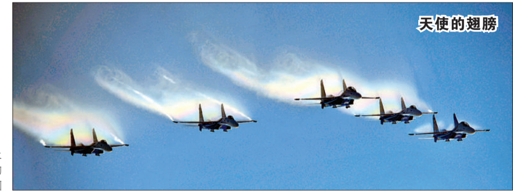
11月15日,珠海金湾机场迎来久违的蓝天,参加珠海航展的各国飞行表演队纷纷振翅比翼。由于空气中含水量较高,而飞机在表演时由于常有大迎角机动动作,导致气流剥离翼面形成翼面附近的真空状态,气温骤降,空气中的水蒸气凝结为雾,所以经常可以看到飞机机翼或翼梢带着美丽的白色水雾,形如飞机的另一双翅膀。图为俄罗斯“勇士”飞行表演队在编队俯冲时产生美丽的彩虹水雾。新华社记者 杨光摄
