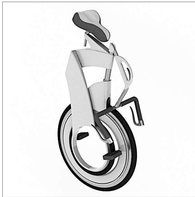
传统自行车也直面创新浪潮。这个设计取消了链条,采用前驱方式,虽然行驶性能有所降低,操控也有所不便,但是便携性能提高了。
