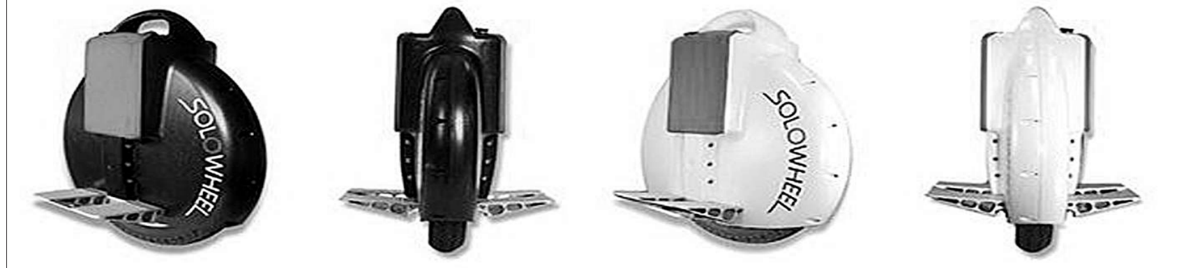
solowheel的产品设计。同赛格威相比,结构大大简化了,对驾驶员者的要求也有所提高。
