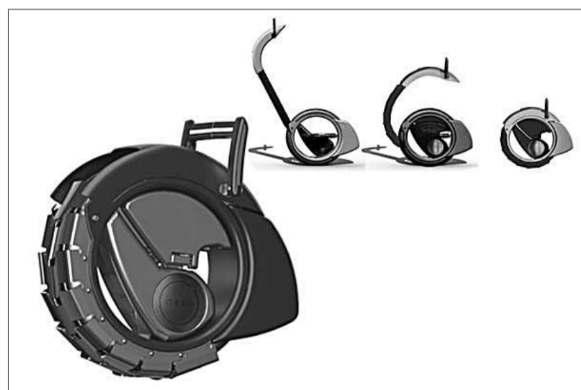
强调行驶性和可折叠的独轮车产品,操纵杆令驾驶更加容易和准确,令驾驶员者更安心,通过复杂的折叠机构来实现便携性能。
